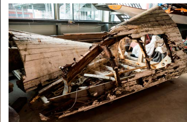
Vragstumperne af verdens længste 12 Meter, Jenetta konstrueret af skotske Alfred Mylne i 1939, er fisket op i Canada og venter nu på en projektmager i Flensborg. Reelt vil der være tale om en nybygning med nogle få stumper fra den oprindelige båd. Også jernkølen på omkring 17 ton vil indgå i genopbygningen. Foto: Søren Stidsholt Nielsen
